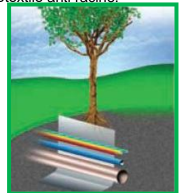
Pose d'un géotextile anti-racines
