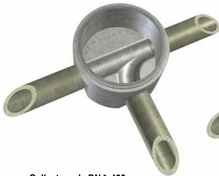
Collecteur de DN \geq 400 mm : adaptation du tracé du collecteur pour une jonction à 60° maximum.
