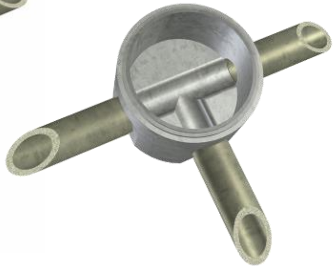
Collecteur de DN \leq 300 : aménagement de la cunette du regard de visite pour une jonction à 60° maximum.
