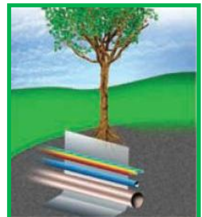
Figure 2 : Protection pour la mise en place d'un arbre à proximité d'un réseau existant
